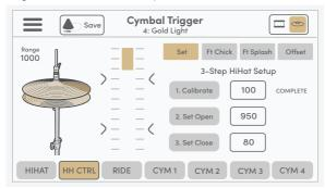
El gráfico de barra de escala y el valor de Range [Rango] indican la posición actual del platillo superior del Hi-Hat en relación con el platillo inferior. Para configurar la función de control de apertura y cierre, siga las instrucciones para cada paso que se muestran a continuación.
